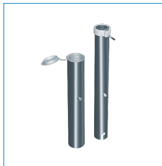
Bodenhülse, 2 teilig, ca. 1,2 kg Standrohr: \varnothing 55 mm Klemmschraube, Abdeckkappe Material: Aluminium Art.Nr.: 490793
